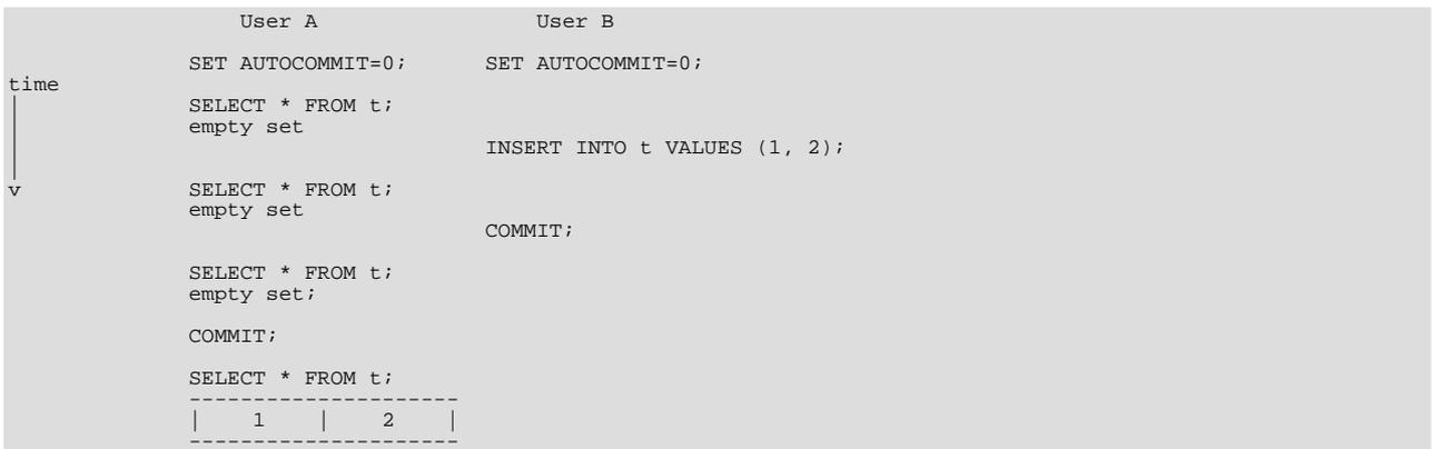
De cette façon, A voit la ligne insérée par B uniquement lorsque B a validé son insertion, et que A a validé sa propre transaction, de façon à ce que la date jalon soit plus récente que la validation de B.
